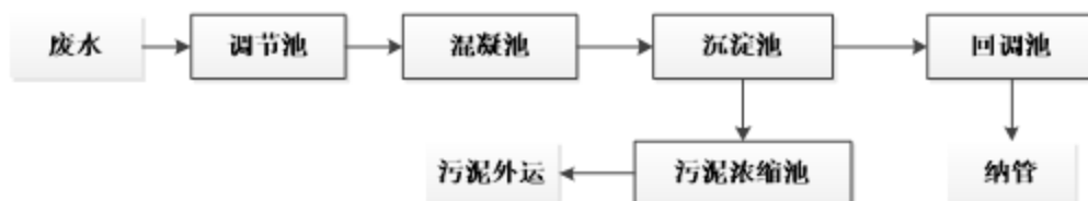
图 2-4 项目废水处理工艺流程图
