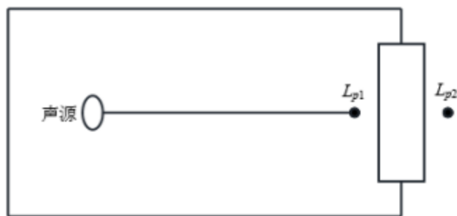
图 4-1 室内声源等效为室外声源图例
